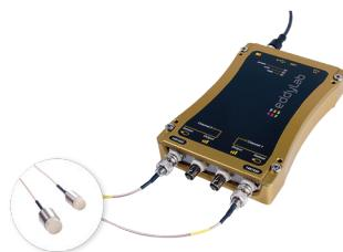
Medición de distancia en metales a través de corrientes eddy, sin contacto y de muy alta precisión y resolución.
